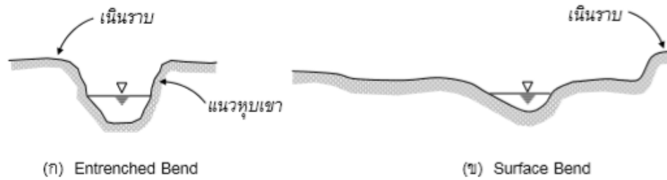
รูปที่ 3: รูปตัดของโค้งน้ำแต่ละประเภท
