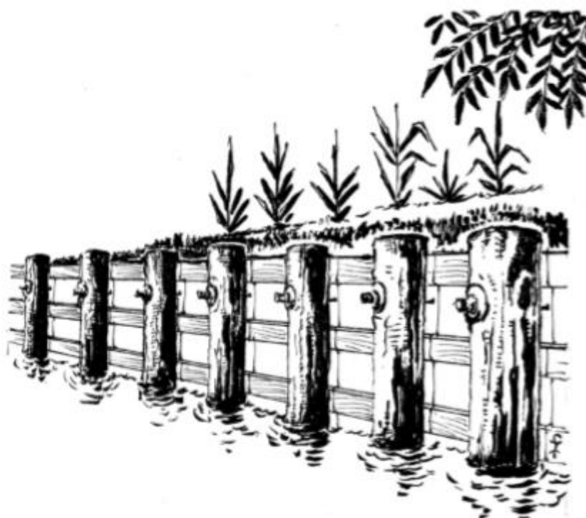
รูปที่ 22: เขื่อนป้องกันตลิ่งแบบ Sheet-Piling Wall
